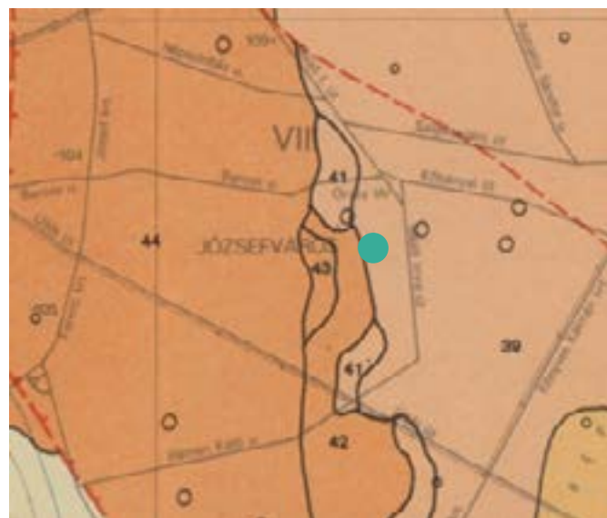
2. ábra – A Diószegi út 18-20 (pirossal jelölve) térségének fedetlen földtani térképe (MÁFI 1982) (Jelmagyarázat: Miocén: 39 homokos agyag, agyagmárga, 41 homokos kavics, konglomerátum, homokkkó; 42 mészkő, mészmárga, 43 kavicsos mészkő, konglomerátum, 44 kőzetlisztes agyag, foraminiferás agyagmárga)
